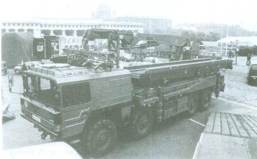
Foto 1: Het 32 ton zware brugslagvoertuig. De goot aan de linkerkant wordt naar achteren geschoven en vervolgens worden de aan elkaar gekoppelde Vorbauträger daar doorheen naar de overkant geduwd.
